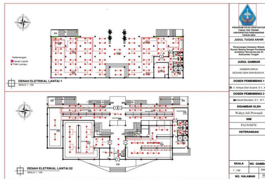
Gambar 40. Denah elektrik lantai 1 dan 2 Gedung Seni
