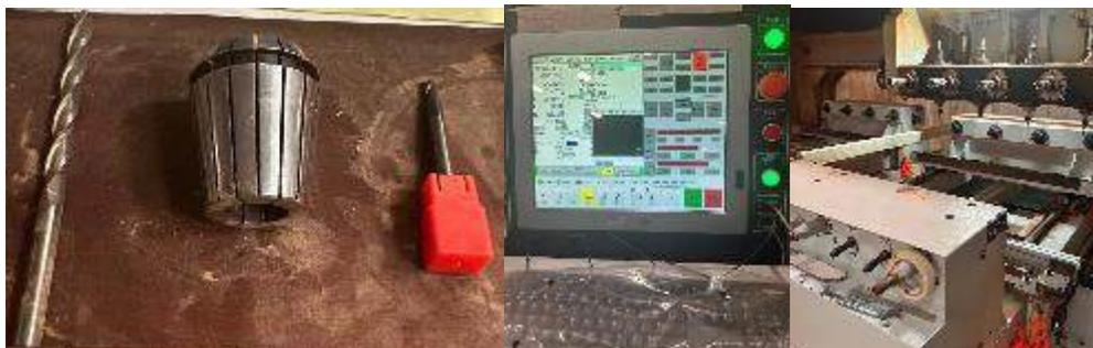
**Gambar 4.** *Setting* pisau router, *collet*, bahan dan program pada *CNC Lathe*
